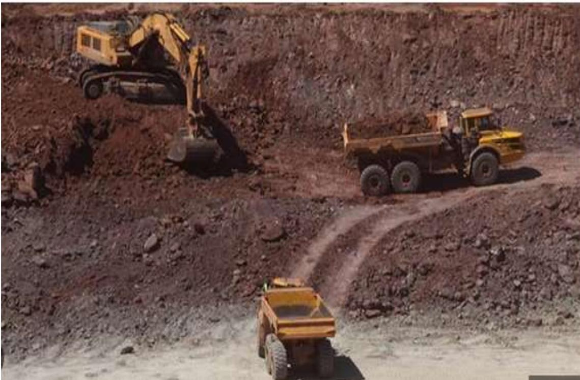
Figura 1: Carregamento e transporte de minério por caminhões na mina de catoca. Fonte: google, [www.catoca.com](http://www.catoca.com).
