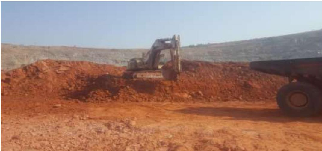
Figura 28: Escavadeira fazendo a carregamento do material desmontado para ser transportado.
