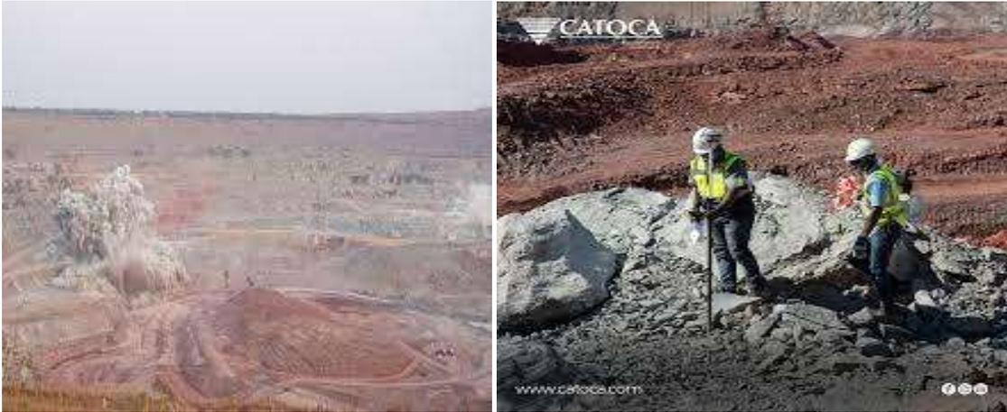
Figura 24 e 25: Desmonte de rochas com explosivos na mina de catoca. Fonte: google, www. Catoca.com.
