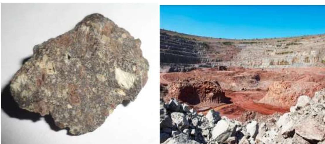
Figura 20 e 21: Rocha kimberlítica e encaixante da mina de catoca. Fonte: google, www.Catoca.com.
