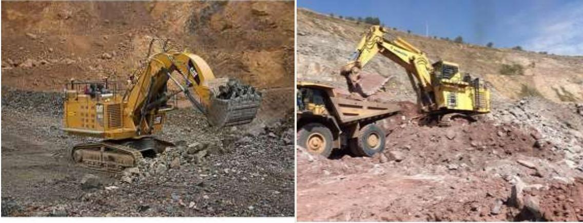
Figura 31: Escavadora frontal e uma retro, carregando um caminhão fora de estrada
